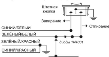
Провод, отключающий штатную сигнализацию при открывании двери ключом, или провод от замка двери, блокирующий случайное отпирание дверей
