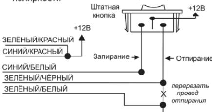
7) Подключение к системе центрального замка автомобиля Ford Probe
