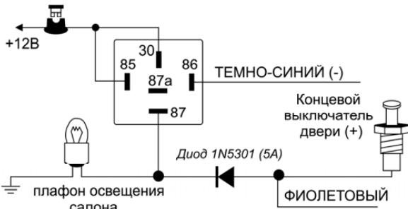
**Подсоединение:** Подсоедините ТЕМНО-СИНИЙ провод к контакту № 86 дополнительного 30A реле и подсоедините контакт № 85 реле к +12B через предохранитель. Подсоедините остальные контакты реле в соответствии с полярностью цепи внутрисалонного освещения автомобиля как показано на схемах.
