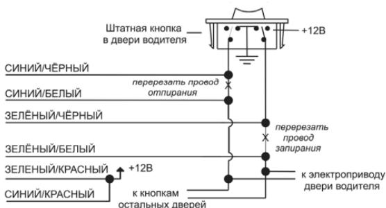
6) 5-проводная система центрального замка с управлением запиранием дверей по плюсу и отпиранием дверей импульсом переменной полярности
