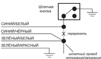
5) 5-проводная система центрального замка переменной полярности
