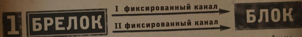
Изначально между брелоком и блоком активны два радиоканала, случайным образом выбранные из 8192-х возможных. В случае, если один радиоканал зашумлен, то передача команды или запроса всё равно состоится по другому радиоканалу. В целом это сильно повышает помехоустойчивость системы.
