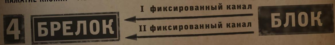
В конце диалогового обмена система "блок-брелок" закрывает дополнительные радиоканалы и возвращается к исходному состоянию - двум рабочим фиксированным каналам.
