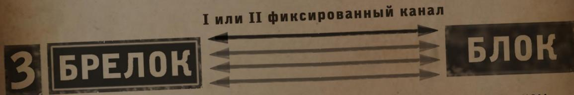
Команда или запрос передаются между участниками обмена в зашифрованном [ с использованием индивидуальных 128-битных ключей шифрования, полученных математически алгоритмом AES ] виде, на четырёх динамически изменяемых каналах. Это обеспечивает высочайшую криптостойкость и высокую скорость нажатия кнопки - менее 0,25 секунды.
