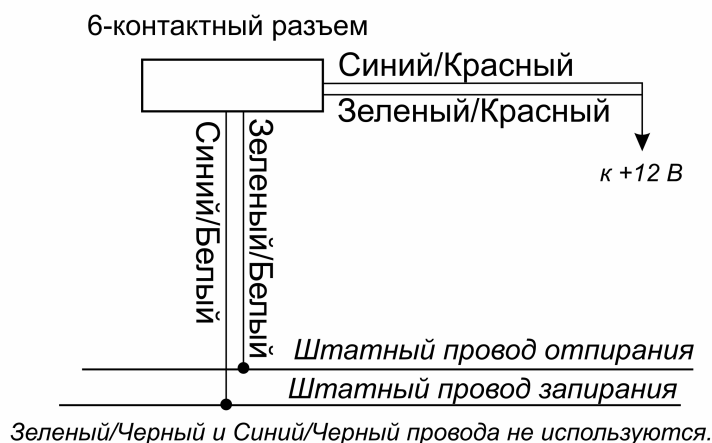
Схема 2. 3-проводная система с положительной полярностью (большинство автомобилей GM)
