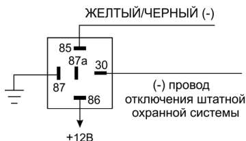
Подключение к (-) проводу снятия штатной сигнализации с охраны с использованием дополнительного реле
